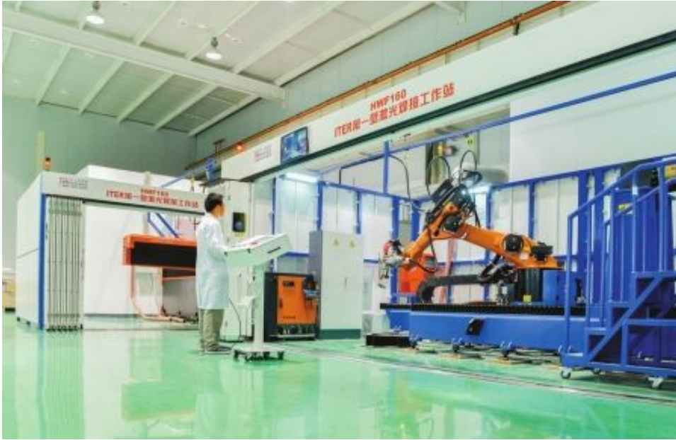
↑ 机器人正在焊接“人造太阳”核心部件“第一壁”设备。（受访单位供图）
